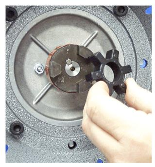
4. Setzen Sie das Kreuz in den Motorverbinder ein.
