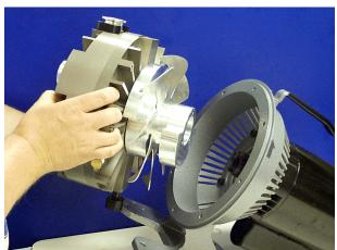
5. Installieren Sie das Pumpenmodul am Rahmen und richten Sie dabei die Finger an der Gebläseeinheit auf die Finger am Verbinder aus. Achten Sie darauf, dass die Dübelstifte genau in die entsprechenden Löcher im Rahmen passen.
